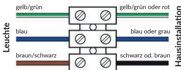
Bei einigen Lampen muss der Schutzleiter nicht an eine Klemme angeschlossen werden, sondern an eine Klemme an Metallteilen der Lampe (Schraube mit Erdungssymbol).
